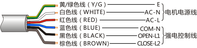
KA80AC型外置电机强电控制接线图
